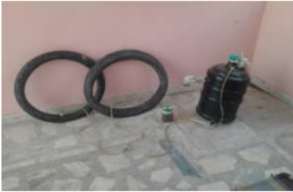
Figure 2: Mini Biogas Digester
